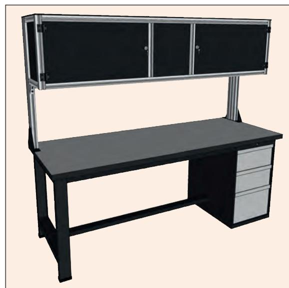
Cette solution de rangement offre un large espace intérieur non cloisonné. Les montants viennent se fixer sur le plateau de vos établis. Les deux portes de 750mm de large par 400mm de hauteur ferment à clé. (2 serrures identiques). Ce coffre réalisé en profilé aluminium est habillé par des plaques PVC extrudé noires. Il supporte une charge totale de 100kg.
