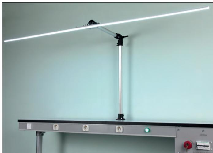
Rampe horizontale enfermant des leds haute luminosité réparties sur la longueur. Montée sur potence, la rampe se situe à environ 2 mètres du sol. Nous adaptons ce type d'éclairage en fonction de l'ergonomie du poste que vous aurez sélectionné.
