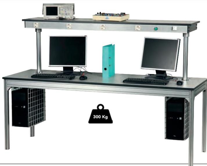
Grande stabilité, aucun mouvement de translation grâce aux profilés aluminium horizontaux de section 80x40mm ainsi qu'aux 4 pieds 40x40mm avec tampons plastiques.
