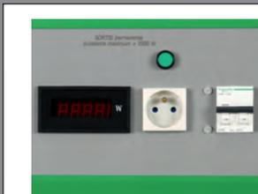
Sortie sur prise 2P+T avec wattmètre d'affichage direct de la puissance consommée. Appareil de mesure 10.000 pts. Puissance Maximum : 3500 W Protection par disjoncteur en face avant.
