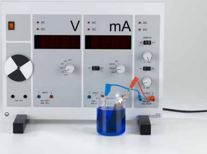
Galvanisation of a metal (C4.4.6.1)
