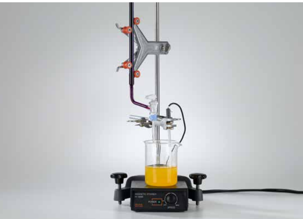
Potentiometric titration of iron(II) ions (C3.5.1.3)
