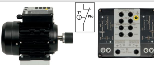
Moteur CA monophasé à 2 condensateurs, 1 de démarrage et 1 permanent
