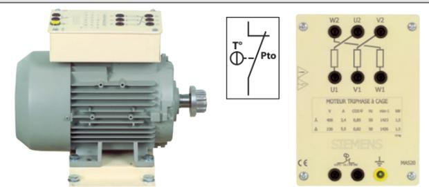
Ce type de moteur fonctionne aussi bien sur **variateur de fréquence** que sur **secteur 50 Hz** en direct
