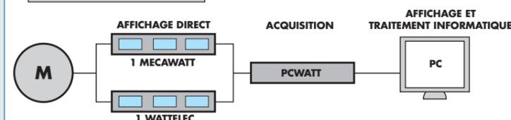
PCWATT-2 permet l'acquisition de grandeurs électriques et mécaniques de différentes machines tournantes. C'est une interface reliant le banc moteur à un PC en addition d'une baie de mesure composée au minimum d'un MECAWATT2 et/ou d'un WATTELEC.
