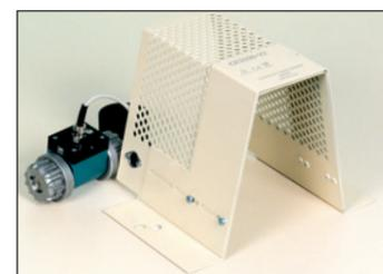
Ces capteurs rotatifs s'installent entre deux machines et mesurent le couple de torsion pour les versions V2 et les couples de torsion + les vitesses pour les versions V22. Il est équipé d'un capteur optique donc sans usure ni entretien, avec une dynamique permettant de mesurer des changements de couple et de vitesse rapides. Les valeurs des démarrages sont donc mesurables sans aucun problème.
