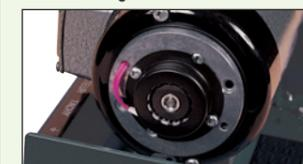
Les machines SH90, AI90 et GE90 sont équipées d'un capteur de vitesse. Il s'agit d'un alternateur tachymétrique délivrant deux informations proportionnelles à sa vitesse de rotation :
