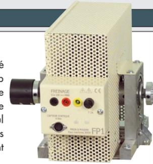
Une protection coupe l'excitation en cas de surchauffe du frein. Un fusible accessible de l'extérieur protège le bobinage du frein en cas de surtension. La mesure de couple nécessite un capteur rotatif à positionner indifféremment à gauche ou à droite. Vitesse de rotation maxi 1800 t/min.
