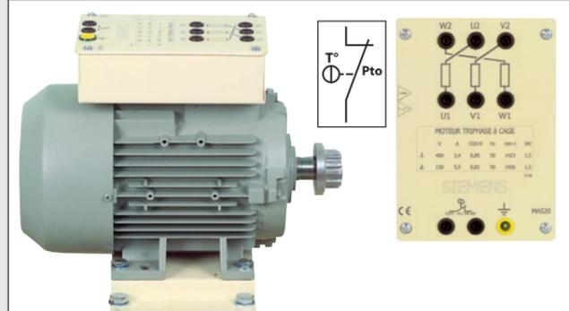
Ce type de moteur fonctionne aussi bien sur variateur de fréquence que sur secteur 50 Hz en direct
