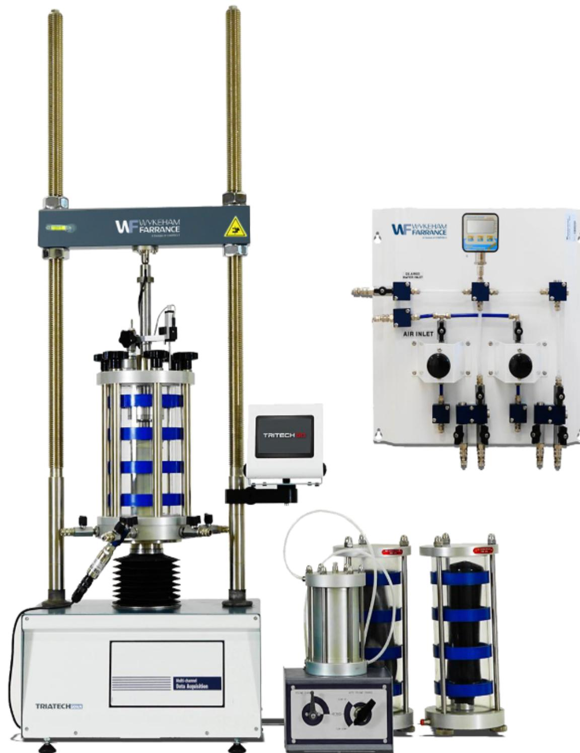
Le système triaxial standard avec acquisition de données intégrée est la solution compacte idéale pour effectuer des tests triaxiaux standard tels que les contraintes effectives et totales.
