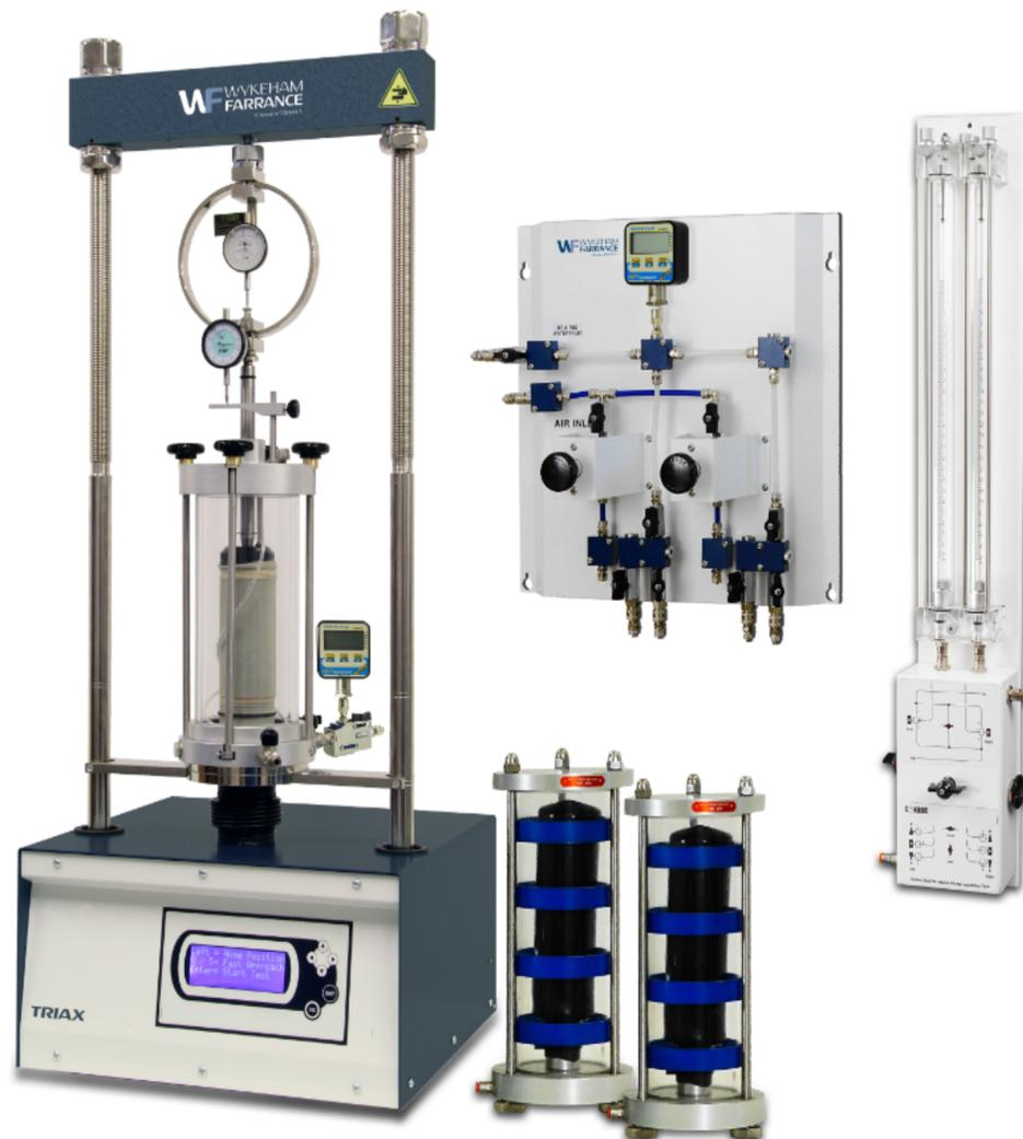
Le système triaxial standard avec mesure analogique est la solution de base idéale pour effectuer des tests triaxiaux standard tels que les laboratoires de contraintes effectives et totales qui ne nécessitent pas de mesure numérique. Toute l'acquisition des données et la gestion des tests se font en mode manuel
