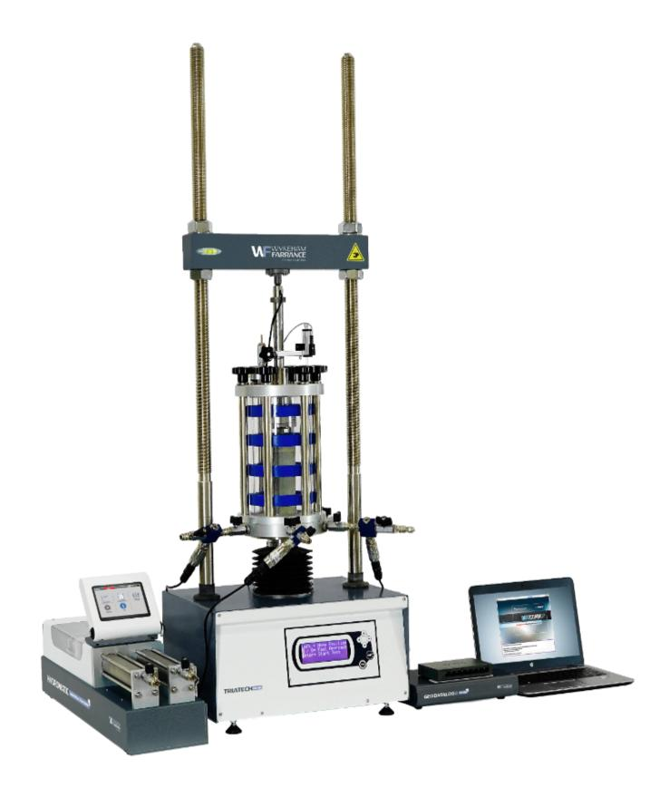
Le système triaxial standard avec acquisition de données externe est la solution compacte extensible pour effectuer des contraintes effectives et totales. L'acquisition de données peut être partagée avec d'autres équipements d'analyse de sol. (p. ex. consolidation, cisaillement, perméabilité).
