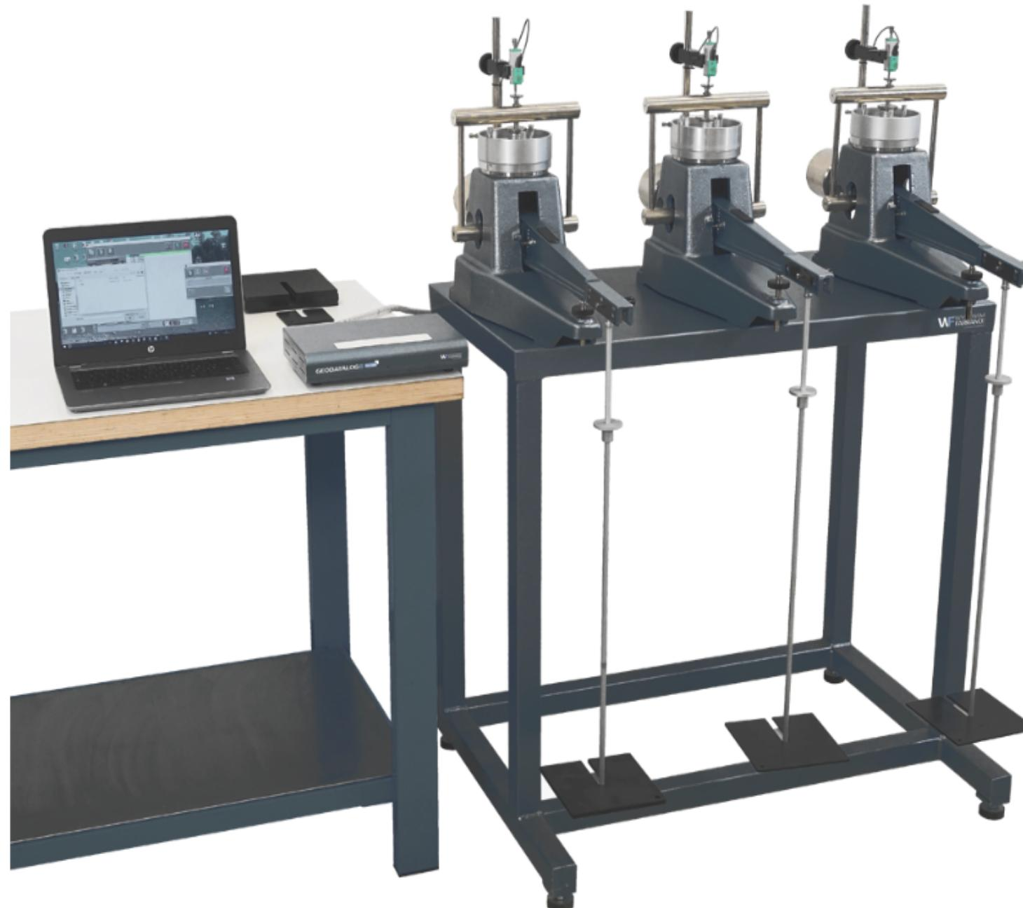
Cet essai détermine la vitesse et l'ampleur de la consolidation d'une éprouvette de sol retenue latéralement et soumise à plusieurs incrément de charge verticale.
