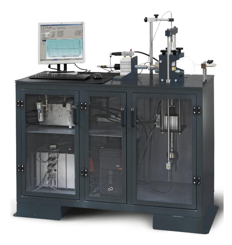
L'appareil de cisaillement simple cyclique est généralement utilisé pour la recherche dans le domaine dynamique du comportement du sol et peut simuler différentes conditions de charge sur le terrain
