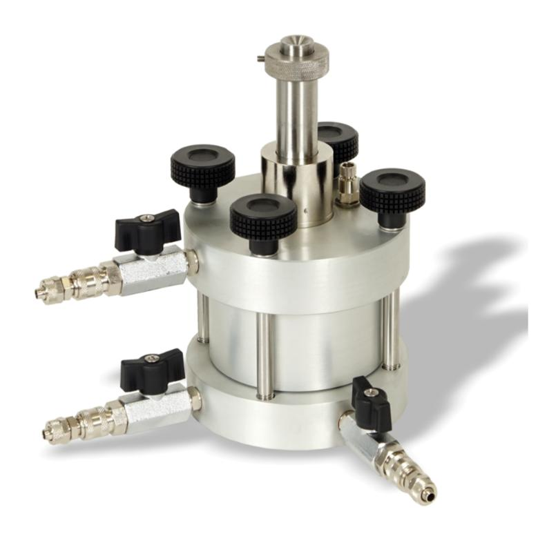
Utilisé pour mesurer l'ampleur et la vitesse de consolidation d'un sol cohésif saturé.
